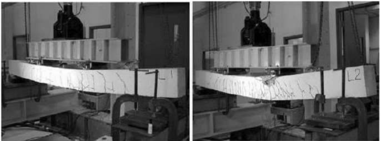
Figure 9: Modelli di fessurazioni per trave ibrida-rinforzata [63]
